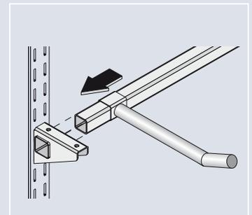
**Rohrkragarme** zur Ringgutlagerung bzw. als Teiler für Senkrechtlagerung.
