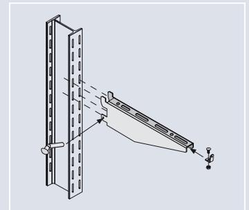
**Kragarme** zur Langgutlagerung, mit oder ohne Abrollsicherung / Teiler.
